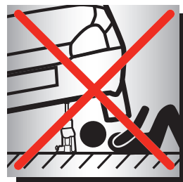
Nunca realize reparos embaixo de um veículo sem cavaletes de apoio
