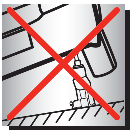
Nunca utilize o macaco em superfícies irregulares ou inclinadas
