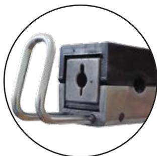
Encaixe para Lâmina de serra e lima.
