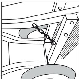
6 - Utilize a corrente para travar a armação superior e limitar a altura.
