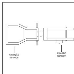
3 - Fixe o suporte vertical (pilar) na armação inferior, nos furos localizados entre o eixo dos rodízios grandes.
