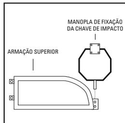
7 - Prenda a manopla entre a chave de impacto e a alça da ferramenta e em seguida, encaixe a manopla na armação superior.
